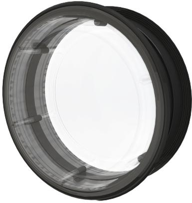
Janela de inspeção circular em policarbonato transparente e resistente a impacto. Adequado para aplicações de HVAC em portas com isolamento Térmico ou duplas. Usado para controle visual de processos enquanto a unidade está em pleno funcionamento. A janela está equipada com uma junta e é adequado para unidades com pressão positiva ou negativa. A montagem usa seis parafusos de aço inoxidável auto-atarraxante de um lado só. Os parafusos são fornecidos com o produto.
